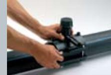
Dévisser le couvercle extérieur. Insérer la clé hexagonale dans la fraise intégrée. Visser dans le sens des aiguilles d'un montre jusqu'à ce que le conduit soit perforé. Ceci sera évident avec la réduction de la force de visseage. Visser dans le sens contraire et remplacer la fraise dans sa position initiale. Retirer la clé hexagonale et visser fermement le couvercle en vérifiant que le joint torique est présent.
