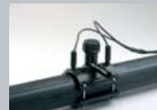
Quitar el tapón superior. Insertar la llave hexagonal en la herramienta cortadora. Enroscar en sentido horario hasta la perforación del tubo. Ésta se notará por una gran disminución de la resistencia. Desenroscar en sentido antihorario y retirar el cortador a su posición original. Retirar la llave hexagonal y volver a enroscar el tapón, comprobando antes la presencia de la junta interior.
